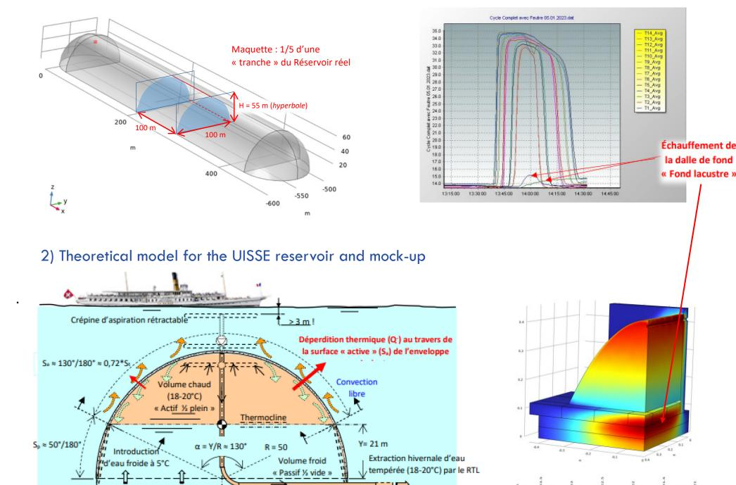
3) Numerical simulation of the Mock-up (COMSOL Multiphysics) Time=1440 min Norme de la vitesse (m/s), Lignes de Courant, Champ des Vitesses
